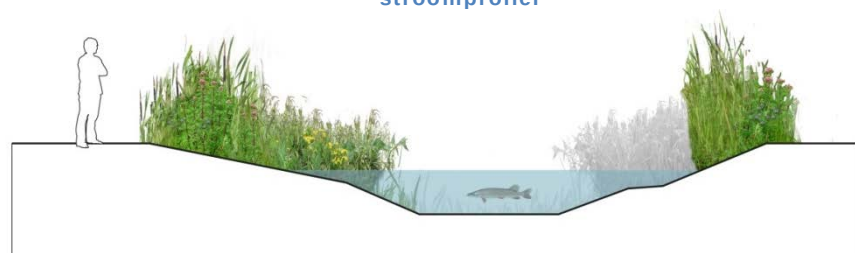
Figuur 11. 3 meter brede stroombaan is vrij in het midden van het stroomprofiel
