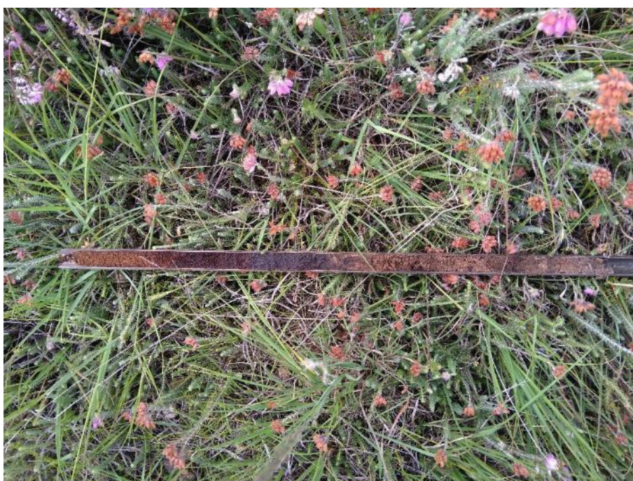
Boorprofiel van de Oldebroeksche Heide uit een van de veenputten, de slecht doorlatende laag zit ca. 80 cm onder het werkelijke maaiveld.
