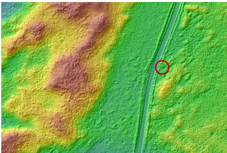
Figuur 3.2: AHN3-kaart van het gebied. De gegraven kuil voor de afwatering van het zandpad is zichtbaar in de rode cirkel.
