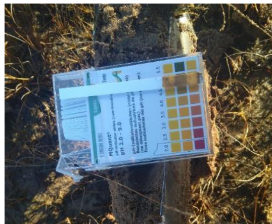
pH in de toplaag van de bodem in De Bieze: links bij de noordelijk uitstroomzijde met pH 3,5 en rechts het zuidelijke bekalkte deel met pH 4,5.
