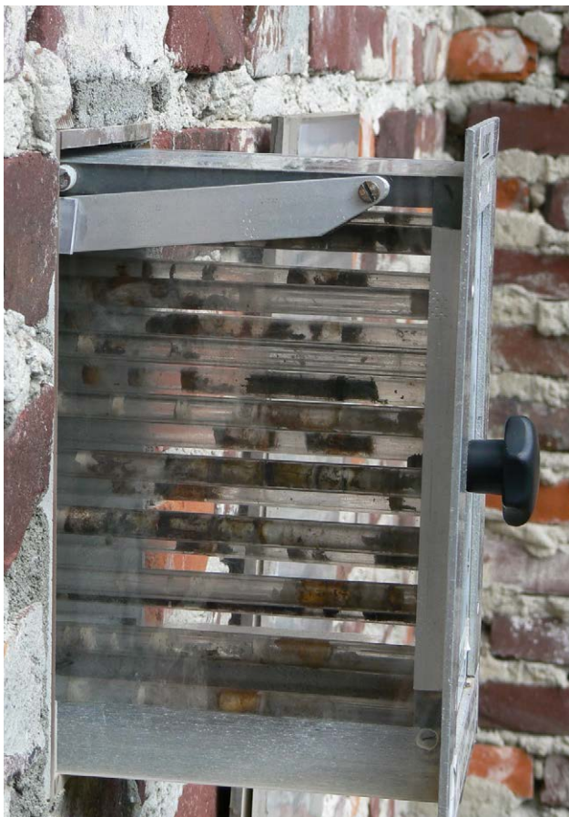
6.41 Zijaanzicht van het naar buiten getrokken kijkkastje van de vorige foto met metalen frame en glasbuisjes.
