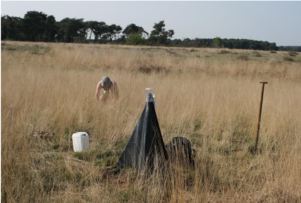
Figuur 2.6: Emergentieval in het veld. Uitgeslopen fauna, met name Tweevleugeligen, wordt opgevangen in de vangpot, gevuld met 4% formaldehyde oplossing die bovenop de val geplaatst is. Emergence traps for local arthropod fauna, especially Dipterans.
