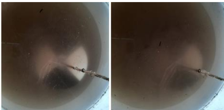
Afbeelding 54. Doorzicht meten. Links zijn de vlakken nog te onderscheiden, rechts niet meer
