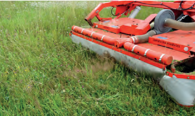
De aangepaste schotelmaaier met blazer voorop ontwikkeld door Welhuis B.V., foto: Kars Veling
