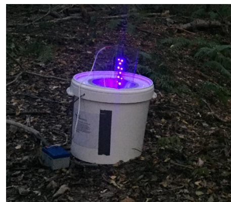
Afbeelding 2.1. De gebruikte lichtval met een blacklight LEDstrip er boven.
